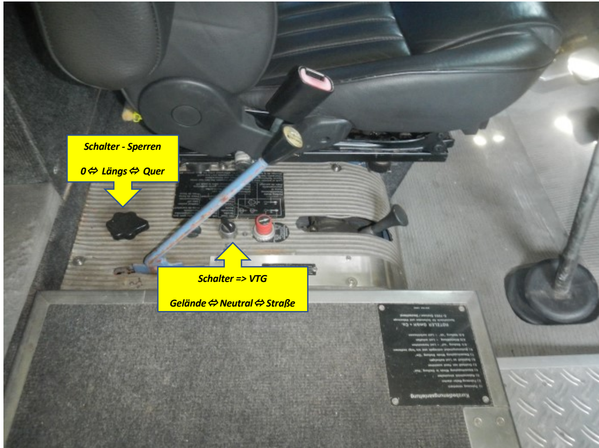
Schaltbox (blauer Hebel für Windensteuerung);
