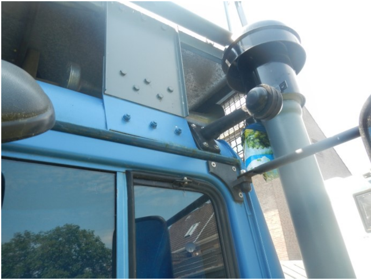
Luftansaugung „hoch“ mit Zyklonen
